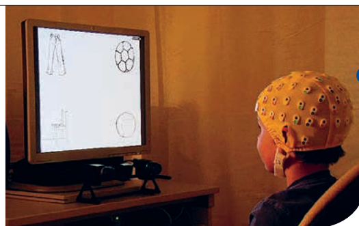
Dispositif de suivi du regard (avec bonnet d'EEG)
